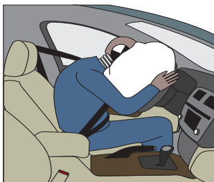
Movimiento del ocupante con el uso del cinturón de seguridad
