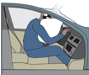
Movimiento del ocupante sin el uso del cinturón de seguridad
